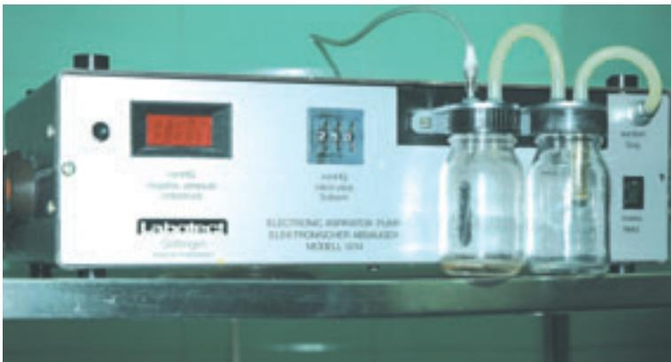
**Εικ. 129:** Ηλεκτρονική αντλία αναρρόφησης τύπου Labotect που χρησιμοποιείται στην ωδηψία. Το επίπεδο της υποπίεσης προεπιλέγεται και ρυθμίζεται αυτόματα με σκοπό την προστασία των ωρίων (αρχείο ΕΥΓΟΝΙΑΣ).
